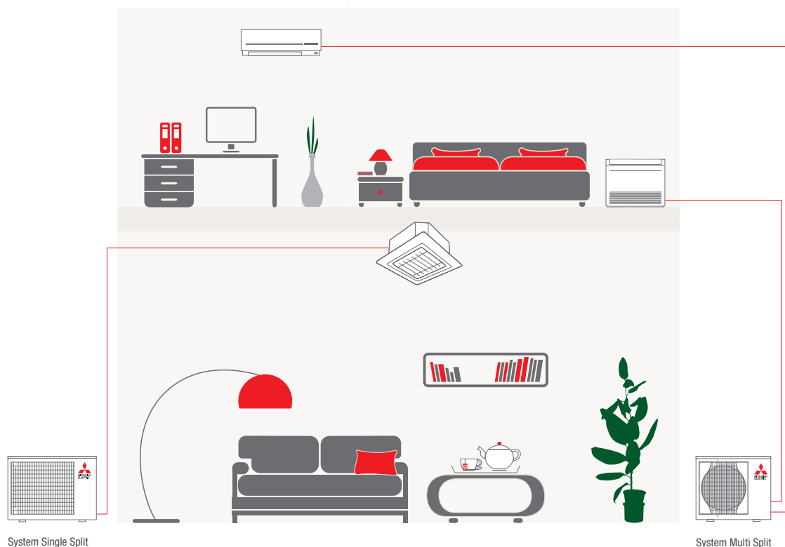
Instalacje Single Split i Multi Split
